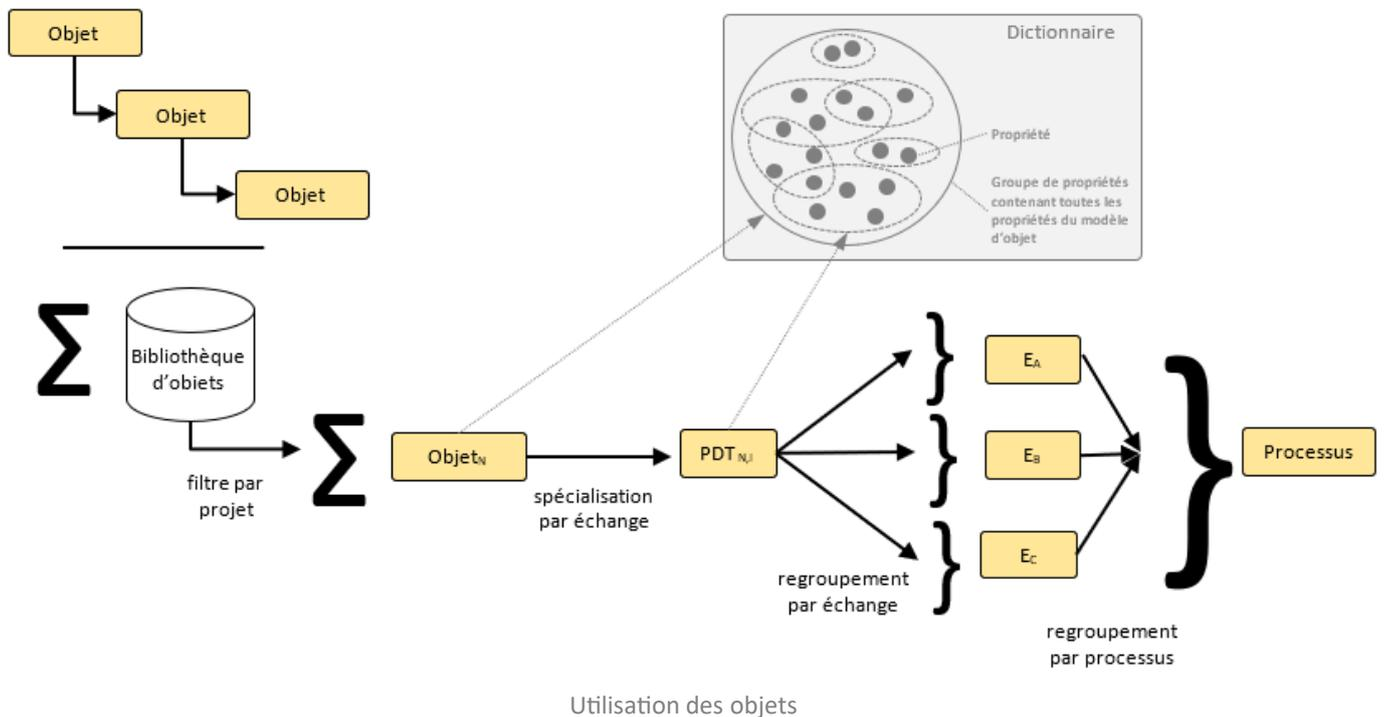
Fig. 10 : Structuration des données pour les échanges
