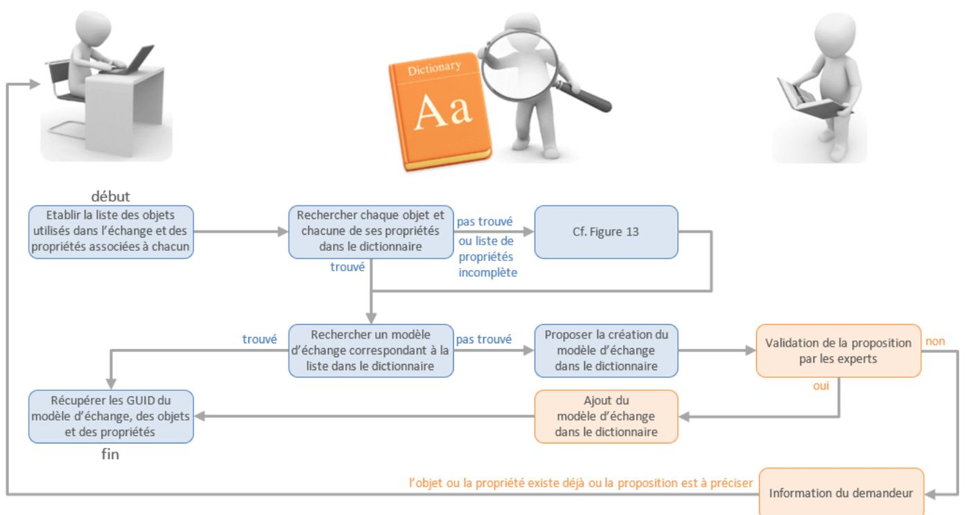
Fig. 14 : Enregistrement d'un modèle d'échange dans le dictionnaire
